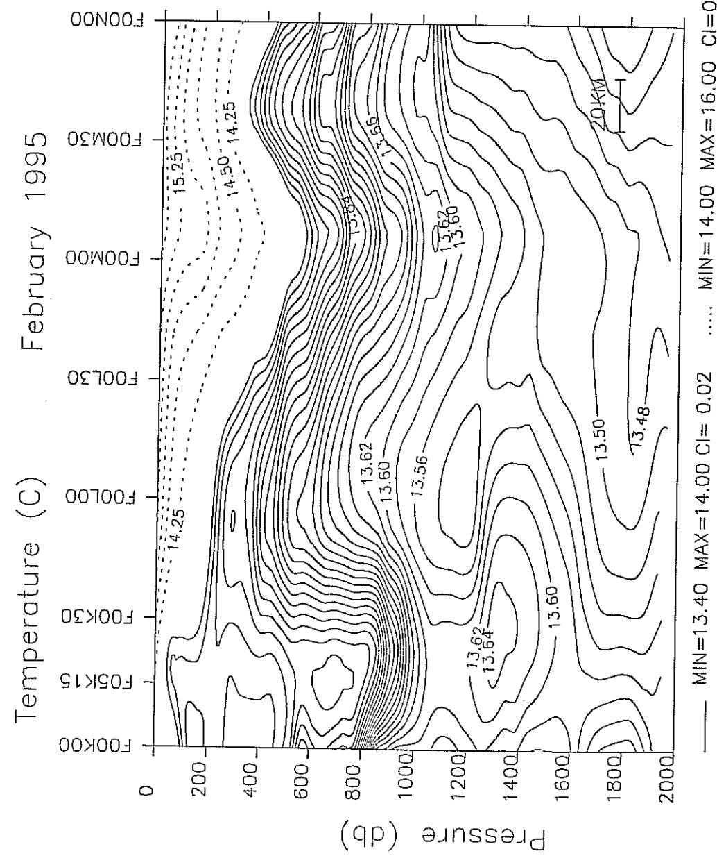
Şekil I.5.6 Şubat 1995 seferinde 35N enlemindeki potansiyel sıcaklık kesiti.
