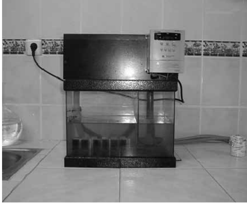
Şekil 1 Laboratuarda kullanılan düzenek, kupon tutucu ve farklı bakteriyel biyofilm materyalleri Figure 1 The laboratory test system, coupon holder and various bacterial biofilm materials
