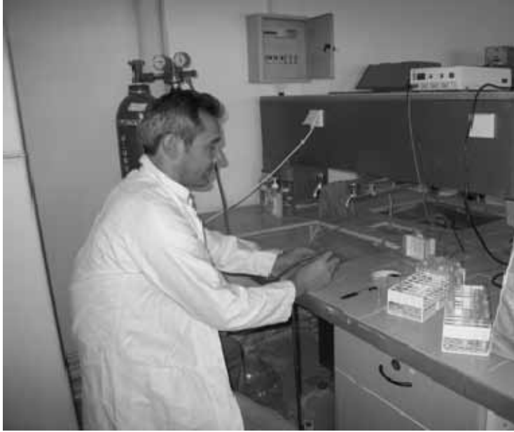
Şekil 2.1. Azot atmosferinde asetonun uzaklaştırılarak örneğin hazırlanması
