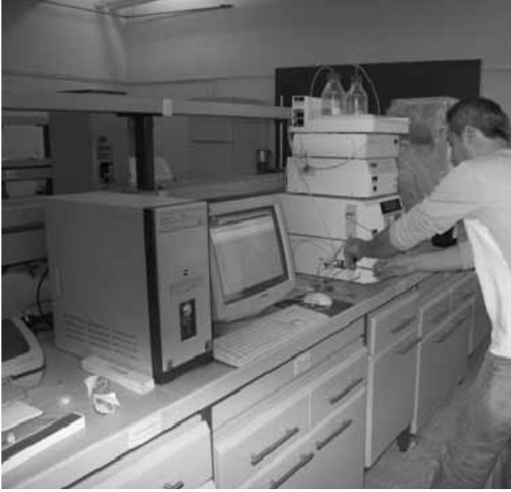
Şekil 2.2. Hazırlanan balık örneklerinin HPLC'ye enjekte edilmesi Figure 2.2. Enjection of prepared fish samples to HPLC system
