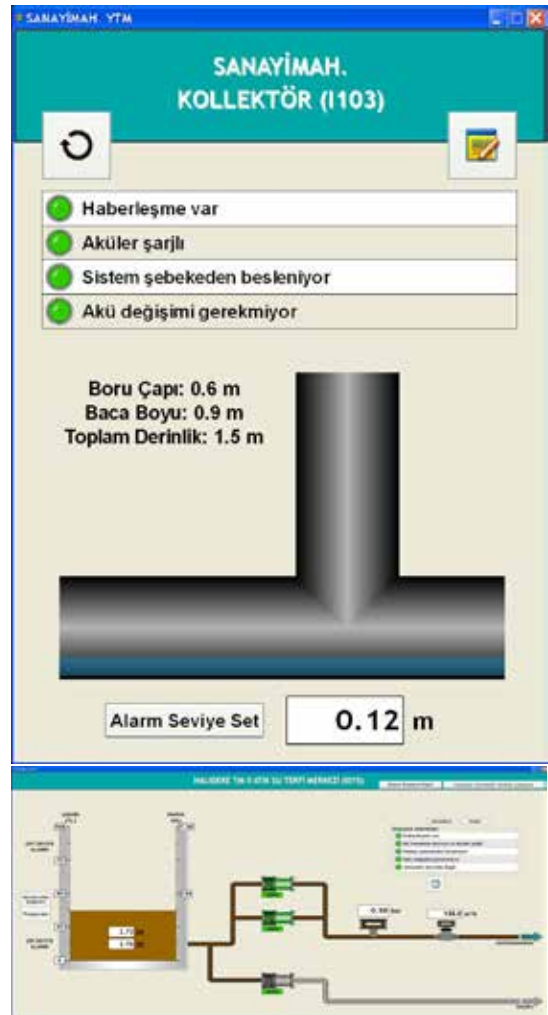
Şekil 2. Atıksu pompa istasyonu kontrol ve izleme paneli
