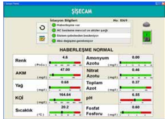
Şekil 3. Online Ölçüm Sistemiyle ölçülen Sanayi Tesisi Ekranı
